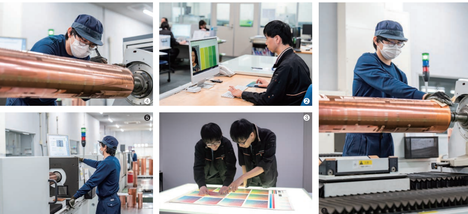
①複数の工程を経て版を完成させる製版部。未経験からでも技術を習得し、段階的に成長できる環境が整う ②専用ソフトで色調整や合成を行い、印刷時の再現性を高める。仕上がりを左右する重要な工程 ③ 入稿データの色が実際のグラビア印刷に再現可能か確認する寺崎さん ④ダイヤモンド針で版面を彫り、インクポケットを形成する彫刻製版を担当する椎さん。繊細な色彩表現を可能にする中核工程 ⑤シリンダーに加工を施す製版工程。彫刻やメッキなど複数の工程を重ね、高精度な版を作り上げていく
